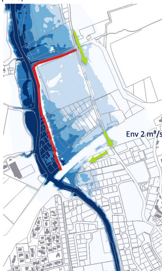
Figure 18 : Evolution de la crue de surté sans dysfonctionnement dans la zone protégée de la RD98
